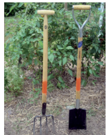
Un tenedor de excavación (arriba) con mango en T y una pala con mango en D
